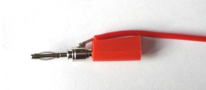
**Montage des Steckers mit Leitung mit Klemmhülse (Pos. 3):**
