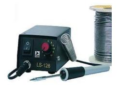
Lötkolben mind. 60 W bleifreier Lötdraht, z.B. SN95,5 Ag3,8 Cu0,7 Soldering iron Unleaded soldering wire, e.g. SN95,5 Ag3,8 Cu0,7
