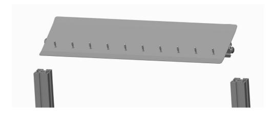
Lösen Sie die Nutensteine der Ablageplatte (Pos. 1) links und rechts mit Hilfe des Inbusschlüssels (Pos. 2) etwas an.
